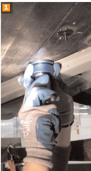
1- Opération manuelle de collage de goujons sur le châssis en fibre de carbone.
