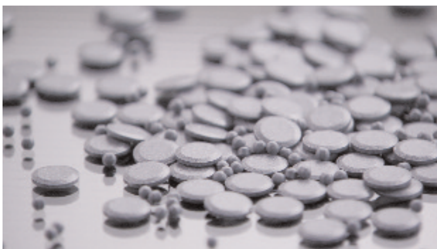
L'adhésif Techbond® Pur sous forme de pastilles et de perles.
