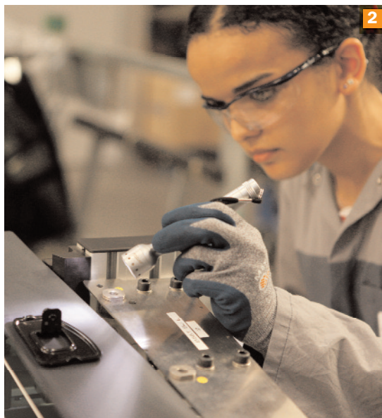
1- Opération manuelle de collage de goujons sur le châssis en fibre de carbone.
